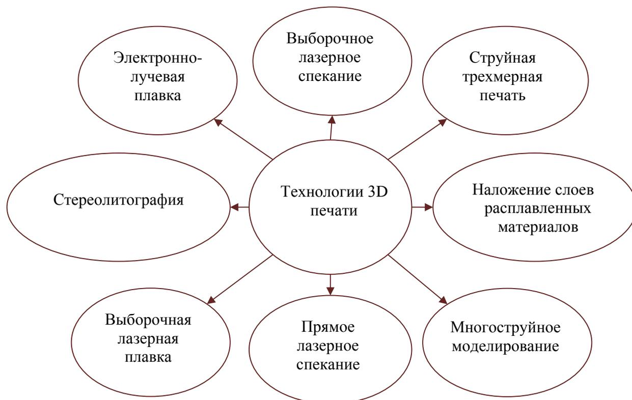
**Рисунок 2.** Технологии 3D печати (разработан автором)
