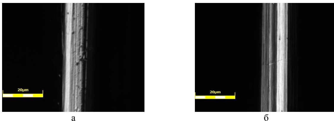
Рисунок 1. КЛСМ изображения поверхности образцов СВМПЭ волокон до (а) и после (б) ВЧ плазменной модификации ( \times 1000 )
