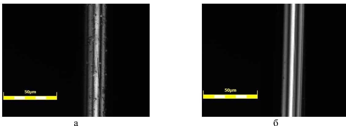
Рисунок 2. КЛСМ изображения поверхности образцов ПА волокон до (а) и после (б) ВЧ плазменной модификации ( \times 500 )
