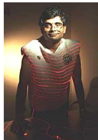
Рисунок 3. Футболка с вплетенными в ткань оптическими и проводящими волокнами, 1996 год (фото из открытых источников, фото Стэнли Лири 5 )
