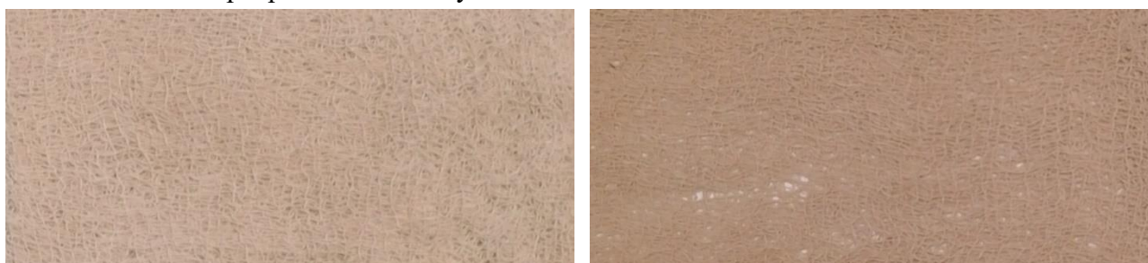
Рисунок 2. Влияние порядка проведения протравных операций в процессе крашения на качество окрашивания текстильных волокон: а — процесс протравления проводился после процесса крашения; б — процесс протравления проводился перед процессом крашения (рисунок авторов)
