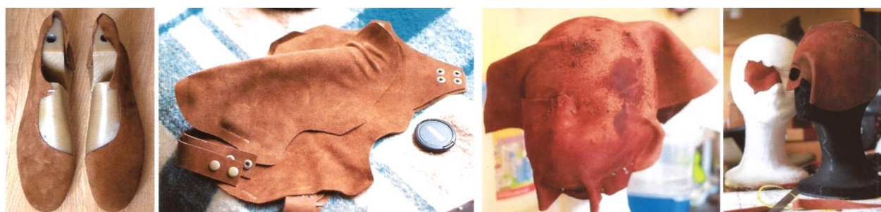
Рисунок 9. Формование гамашей на колодке и готовые изделия, изготовление масок, архив кафедры ХМК и ТИК, РГУ им. А.Н. Косыгина, автор коллекции Лоткова А.Е. [1]
