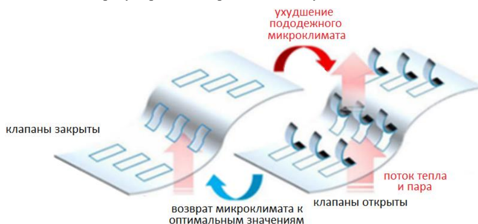
Рисунок 7. Принцип действия текстильных материалов со свойством регулирования конвективных потоков [23]
