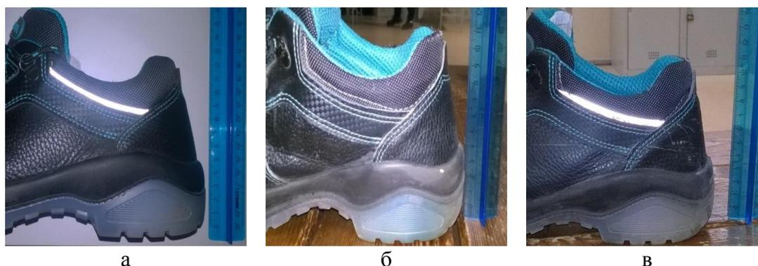
**Рисунок 8.** Пяточная часть обуви специального назначения: в начале носки (а); в середине носки (б); в конце носки (в)
