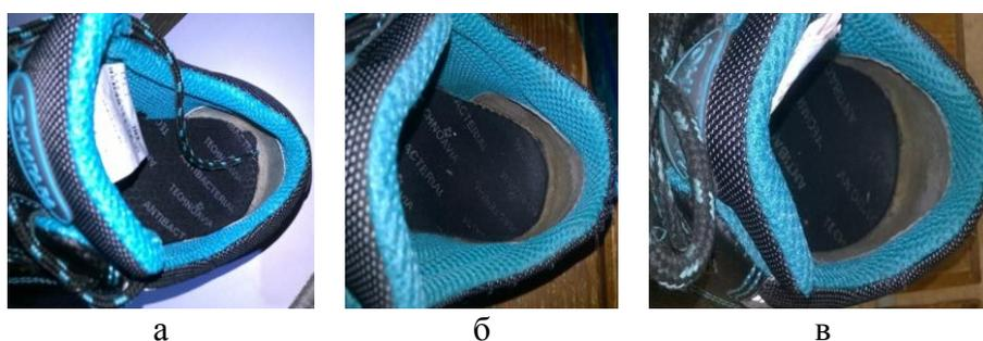
**Рисунок 9.** Внутренние детали верха обуви специального назначения: в начале носки (а); в середине носки (б); в конце носки (в)
