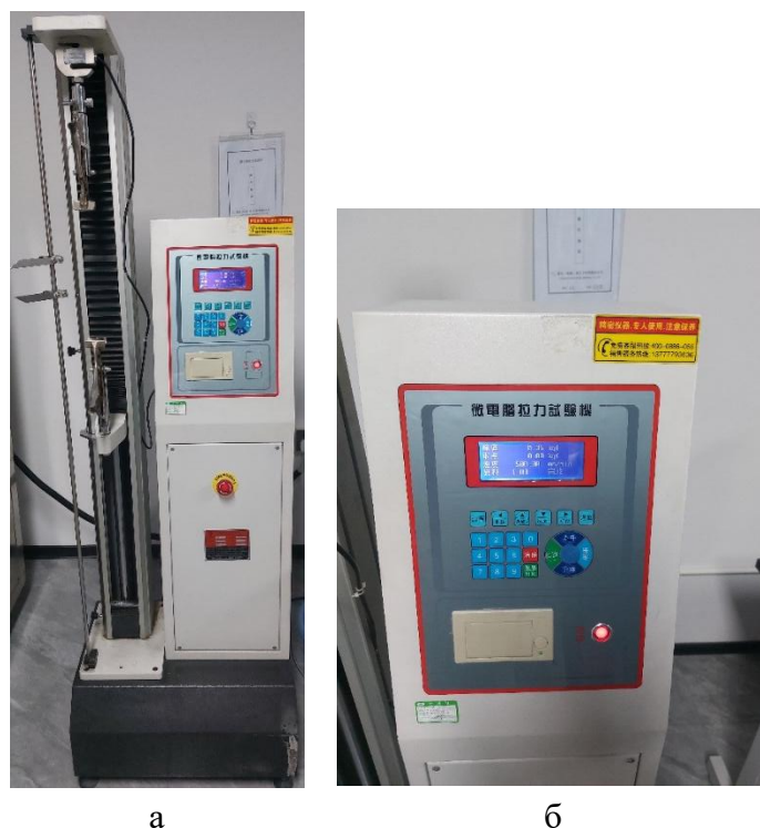
Рисунок 10. Внешний вид: а — универсальной испытательной машины на растяжение; б — сенсорного экрана (фото авторов)
