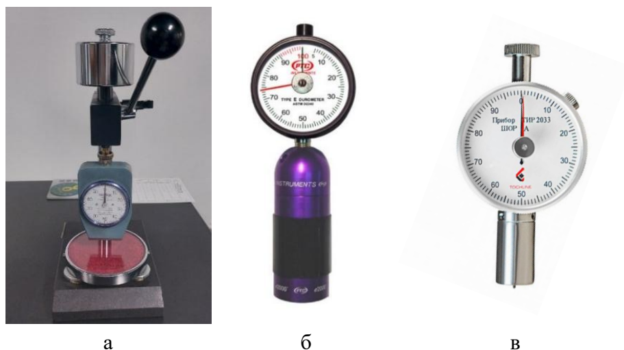
Рисунок 7. Внешний вид твердомеров по Шору: а — GS-701N
