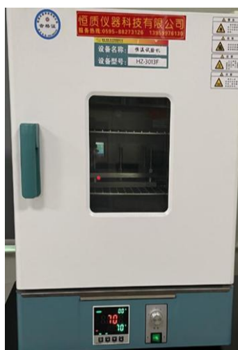
Рисунок 17. Внешний вид лабораторного сушильного электрического шкафа с термостатом и постоянной циркуляцией воздуха марки HZ-3013F (поставщик Hengzhi Instrument Technology Co., Ltd) (фото авторов)
