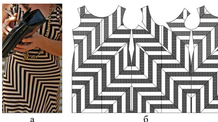
Рисунок 8. Фото изделия и результат перевода вытачек при совмещении БЛСНВ с параллельными рельефами, проходящими под углом к центру детали через внутренние концы исходных вытачек (авторская разработка конструкции)
