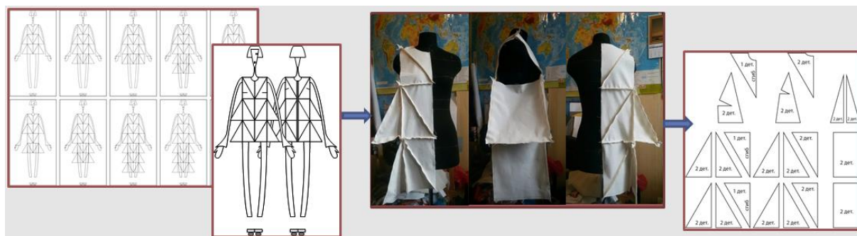
Рисунок 4. Пример последовательности проектирования модульной конструкции из повторяющихся унифицированных деталей треугольной формы (разработано авторами)
