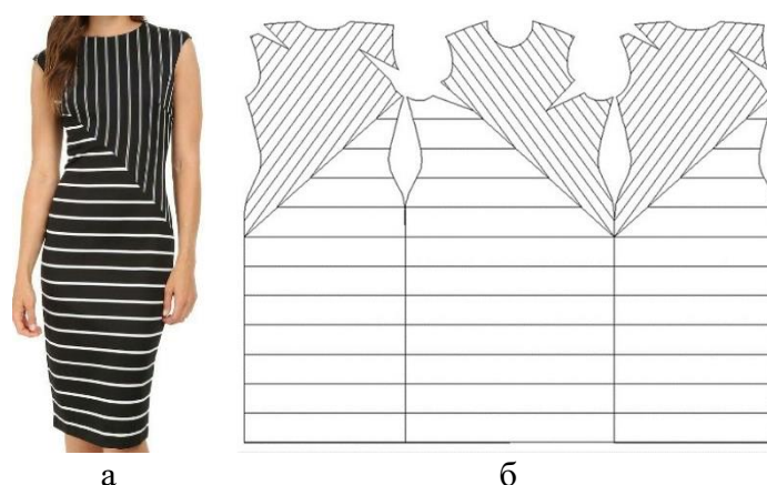
Рисунок 5. Фото изделия и конструкция с совмещением по шву рисунка полосы разнораппортных материалов с помощью рассчитанного угла (авторский чертёж)
