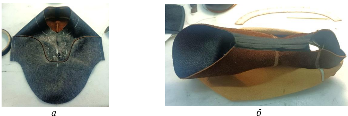
Рисунок 7. Состроченные наружные детали верха (а), заготовка верха обуви, вывернута (б) (фото: асп. Бурцев А.И., рук. Карасева А.И.)
