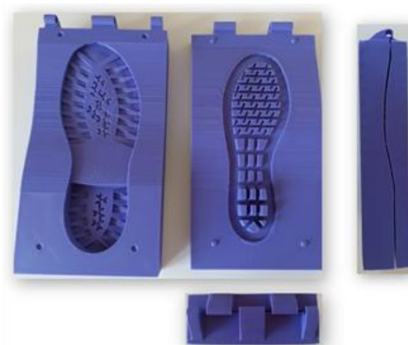
Рисунок 3. Прототип макета пресс-формы, распечатанный на 3D-принтере из PLA пластика в масштабе 1:2 (разработано авторами)
