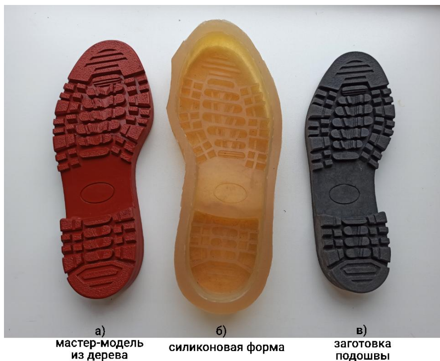
Рисунок 1. Мастер-модель подошвы, изготовленная традиционным копировальным методом с применением ручного фрезерования эталона из древесины (образец из архива кафедры художественного моделирования, проектирования и технологии изделий из кожи РГУ имени А. Н. Косыгина)
