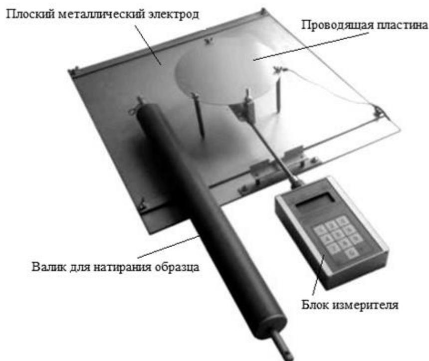
*Рисунок 1. Измеритель СТ-01 в подготовленном для испытания виде*
