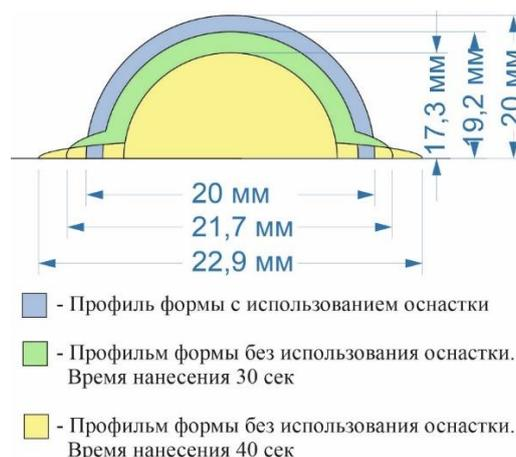
*Рисунок 1. Анализ профиля полимерной формы при нанесении в различных режимах*
