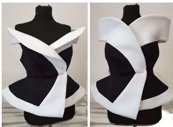
Рисунок 7. Анализ свойств формоустойчивости в изделии из неопрена: а – до стирки; б – после стирки
