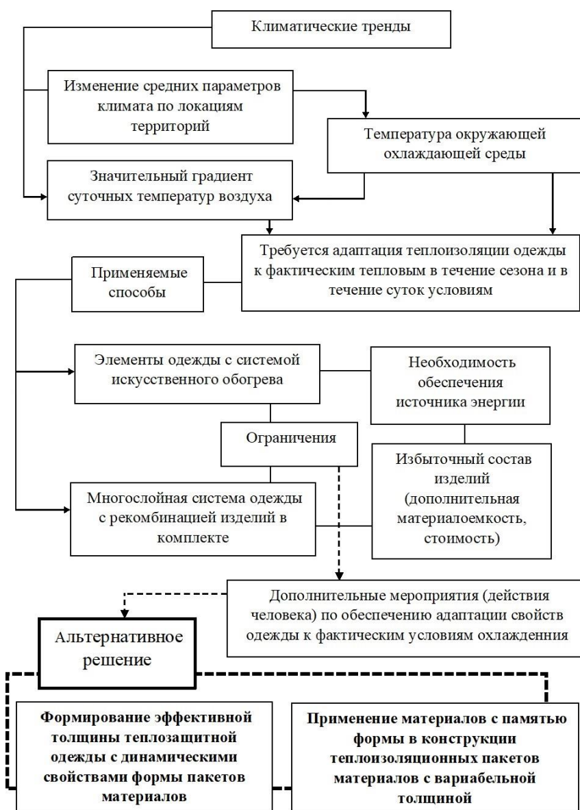
Рисунок 1. Логическая схема формирования функциональности пакетов материалов теплозащитной одежды с учётом градиента температур окружающей охлаждающей среды (рисунок авторов)
