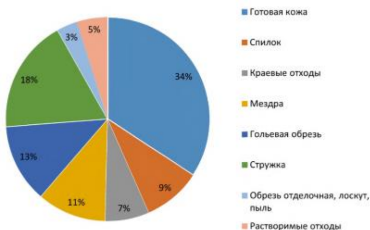
Рисунок 1. Диаграмма образования коллагенсодержащих отходов
