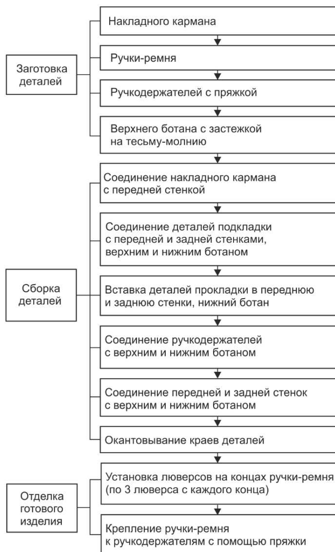
Рисунок 4. Схема технологической обработки сумки кросс-боди (рисунок авторов)
