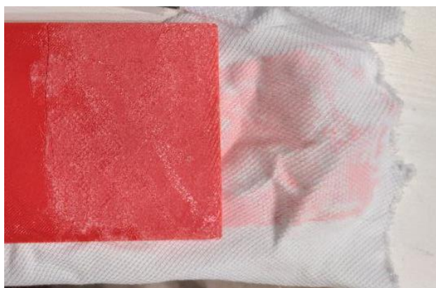
Рисунок 1. Структура разрыва при испытании на адгезионную прочность
