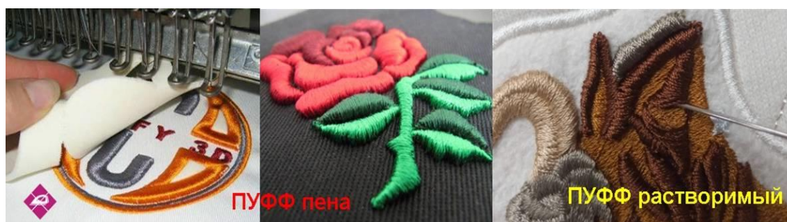
Рисунок 7. Примеры применения пуффа в машинной вышивке (фото авторов)
