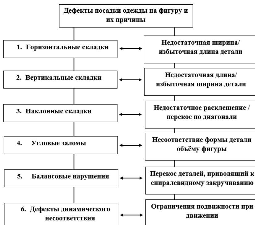
Рисунок 1. Схема конструктивных дефектов (составлена авторами)
