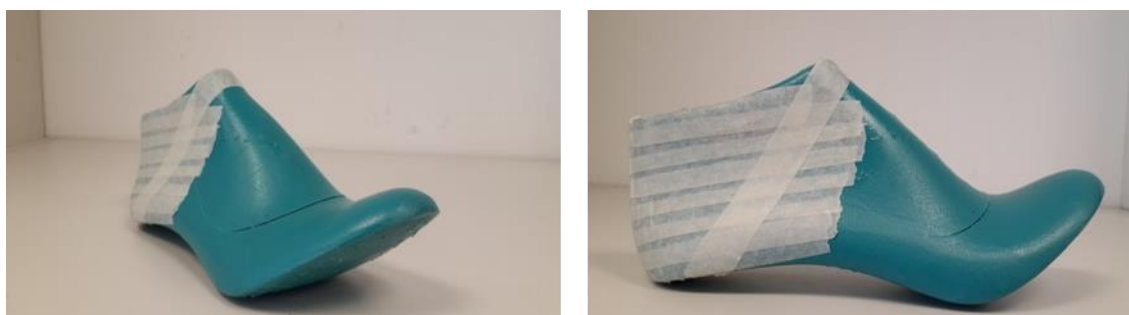
Рисунок 5. Начало обклеивания геленочной части колодки бумажным скотчем (из открытых источников Internet)
