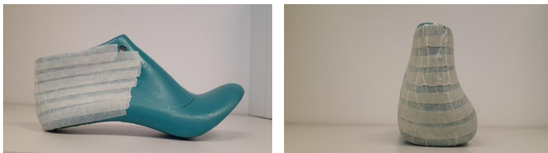
Рисунок 4. Обклеивание боковой поверхности пяточной части бумажным скотчем (из открытых источников Internet)
