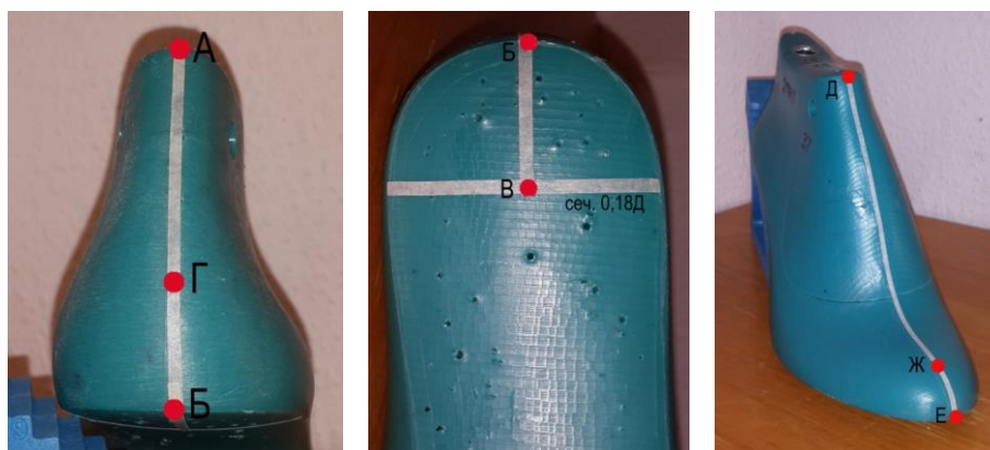
Рисунок 7. Проведение граничных линий (из открытых источников Internet)
