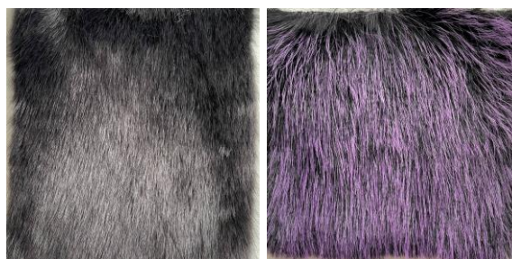
Рисунок 4. Результат стачивания деталей строчкой цепного переплетения с лицевой стороны (составлено автором)
