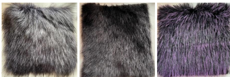
Рисунок 3. Результат стачивания деталей строчкой челночного переплетения с лицевой стороны (составлено автором)
