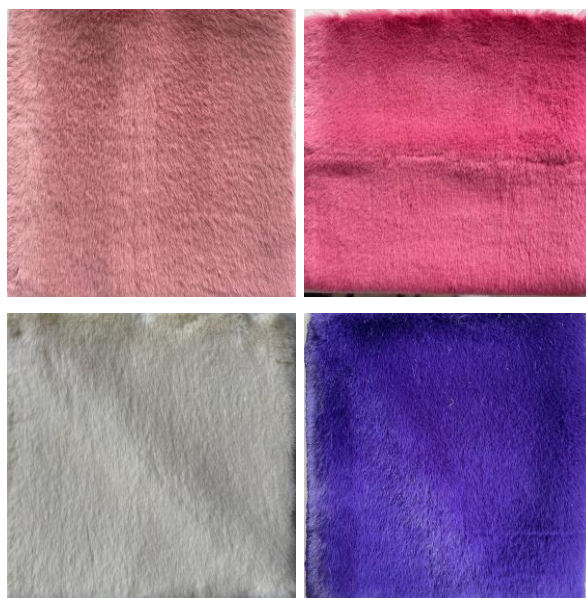
Рисунок 1. Результат стачивания деталей строчкой челночного переплетения с лицевой стороны (составлено автором)
